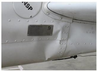
Fig. 03 Bulging on LH side empennage area
